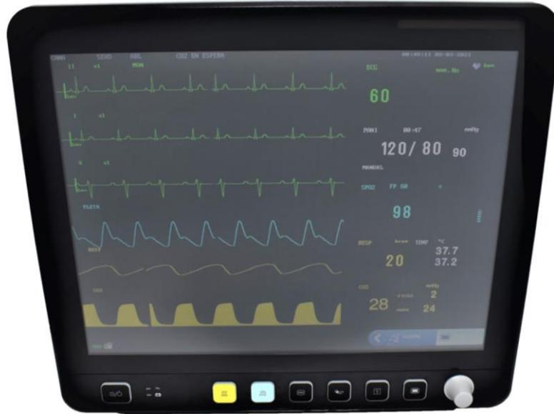
El monitor E15 es un equipo con tecnología TÁCTIL que permite controlar diferentes parámetros como la tensión arterial, la respiración, el ECG, SPO2 y la temperatura. Cuenta con una gran pantalla TFT a color de 15". La pantalla es extraíble para poder cambiarla por otros formatos de mayores dimensiones si fuera necesario.
